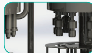
Cabeçotes tampadores com regulagem de torque individual.
