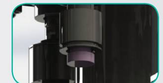
Castanha do tampador para cada modelo de tampa, podendo ser por pressão, rosca ou pinça.
